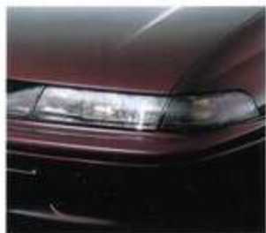
①フォグランプ一体プロジェクターヘッドランプ
