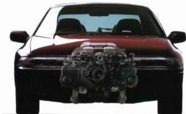
水平対向6気筒エンジン
