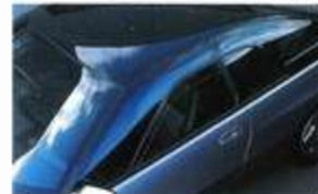
UVガラスのラウンドキャノピーとミッドフレームウィンドウ
