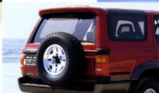
LEDハイマウントストップランプ付リヤスポイラー (SSR-Gに標準) & バックドア付スベアタイヤキャリア (SSR-Gに標準, SSR-Xワイドボディにオプション)
