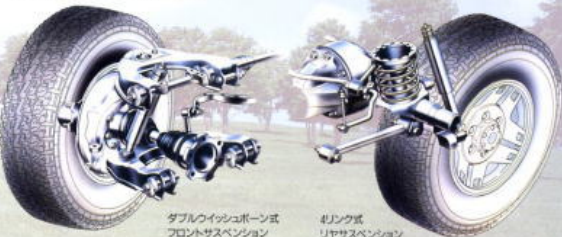
ダブルウィッシュボーン式 フロントサスペンション
