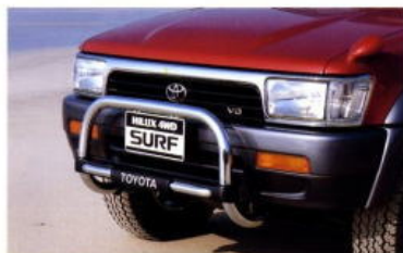
フロントバンパーガード (SSR-G, SSR-Xに標準, SSRにオプション) & 異形ハロゲンヘッドランプ (全車に標準)
