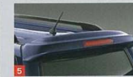
5 リヤスボイラー (LED式ハイマウントストップランプ付) 点灯速度の速いLEDをハイマウント ストップランプに採用することで、 後続車への視認性を向上させています。
