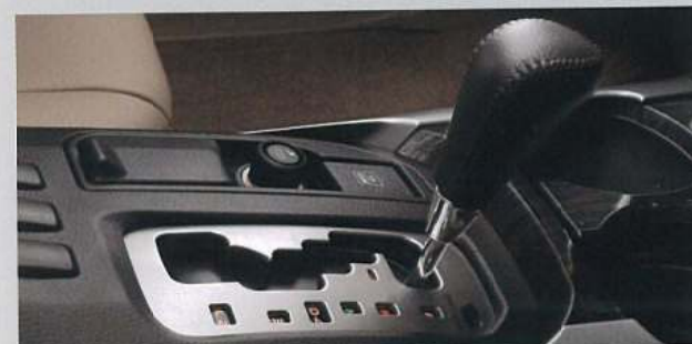
ゲート式A/Tシフトレバー スポーティな操作感覚が楽しめるゲート式を採用。 また、SSR-Gにはしっかりと手になじむ、本革巻シフトノブを採用。
