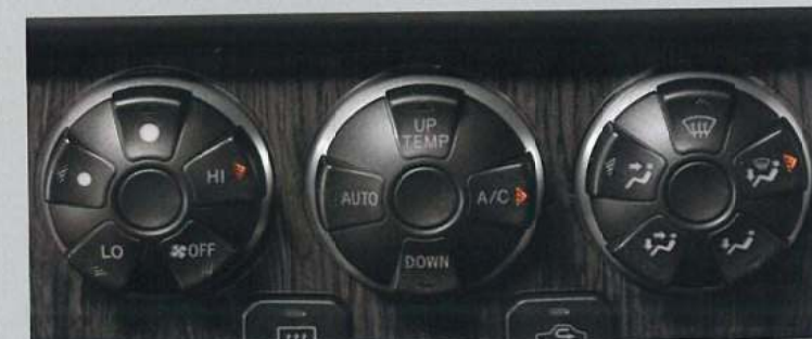
ジョイカップ式ヒーターコントロールパネル 円形カップの各部を押して操作する、斬新なヒーターコントロールパネル。 ゲーム機のコントローラのような操作感覚を味わうことができます。 (左のスイッチ部より: 風量調節スイッチ/温度調節・AUTO・A/Cスイッチ/吹き出しモード切替スイッチ)
