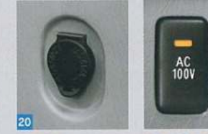
20 DC12V コンセント (デッキサイドトリム部)
