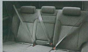
後席ELR付3点式シートベルト (チャイルドシート固定機構付) & 後席ヘッドレスト
