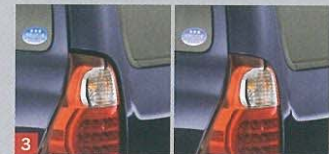
3 イージークローザー付バックドア （左：半ドア状態 右：全開状態）
