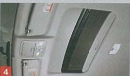
4 チルト&スライド電動式 ムーンルーフ （挟み込み防止機構+可変デフレクター付き）
