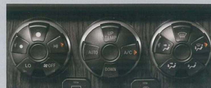
ジョイカップ式ヒーターコントロールパネル 円形カップの各部を押して操作する、斬新なヒーターコントロールパネル。 ゲーム機のコントローラのような操作感覚を味わうことができます。 (左のスイッチ部より: 風量調節スイッチ/温度調節・AUTO・A/Cスイッチ/吹き出しモード切替スイッチ)
