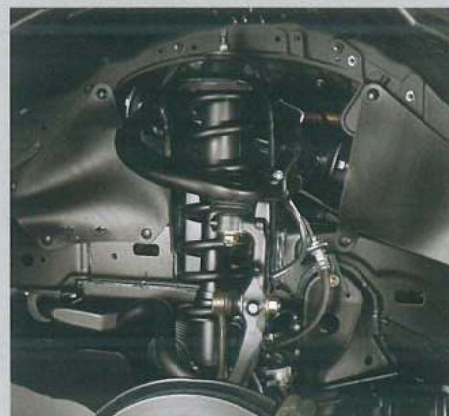
ダブルウィッシュボーン式フロントサスペンション
