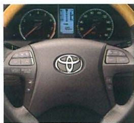
ステアリングスイッチ (メーカーオプションのHDDナビゲーションシステム装着時)
