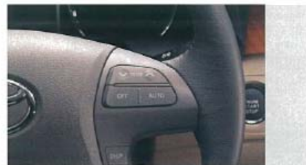
ステアリングスイッチ(メーカーオプションのHDDナビゲーションシステム装着車) ステアリングからもエアコンの温度調節が可能です。
