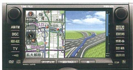
HDD ナビゲーションシステム(メーカーオプション)
