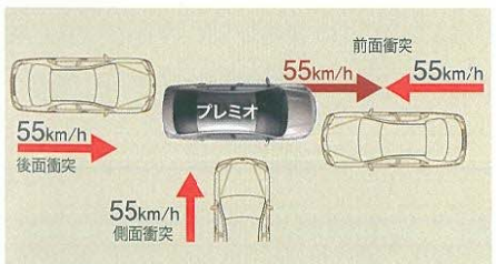
全方位コンパティビリティボディ構造イメージ(同クラスの車両衝突)
