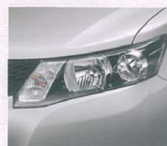
ディスチャージヘッドランプ (マルチリフレクター・オートレベリング機能付)
