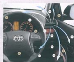
プラズマクラスター® (エアコン使用時、運転時にドライバー側の吹き出し口からイオンを放出します。) ※プラズマクラスター、プラズマクラスターイオンおよびPlasmaclusterはシャープ株式会社の商標です。
