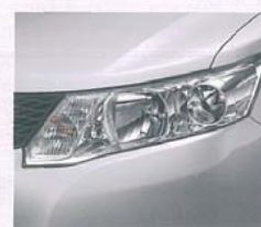
ハロゲンヘッドランプ (マルチリフレクター・マニュアルレベリング機能付)
