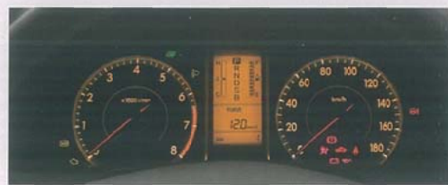
スポーツオートメーター (メーター照度コントロール・マルチインフォメーションディスプレイ付)
