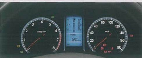
オートメーター (メーター照度コントロール・マルチインフォメーションディスプレイ付)
