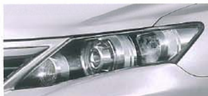
ディスチャージヘッドランプ (プロジェクター式ロービーム・オートレベルリング機能付) (A20“Sパッケージ”・A18“Sパッケージ”に標準装備。その他にメーカーオプション)
