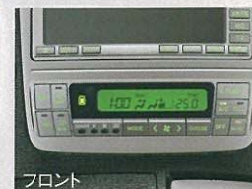
デジタルプッシュ式ヒーターコントロールパネル
