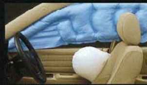
SRSサイドエアバッグ+カーテンシールドエアバッグ (運転席・助手席)
