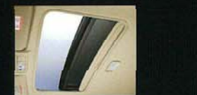
マイコン制御付スライド電動式ムーンルーフ (ワンタッチ開閉・後み込み防止機構付)
