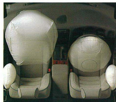
写真は機能説明のためにすべてのSRSエアバッグが作動した状態を再現したものです。なお、SRSサイドエアバッグは、実際の衝突時には衝突側のみ膨らみます。
