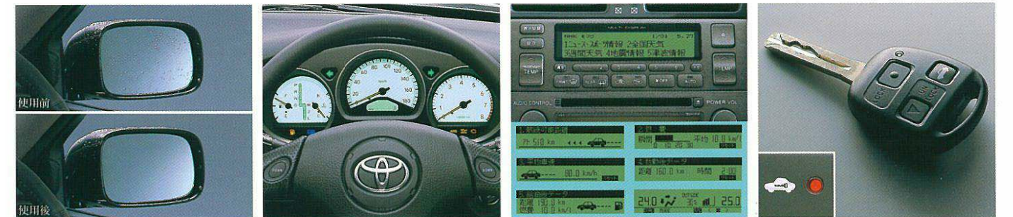
⑨ 電動格納式リモコンカラードアミラー (ヒーター付レインクリアングドアミラー) 鏡面に特殊コーティングを施し、水滴を膜状に広げることによって、内蔵されたヒーター機能とともに雨天時の視認性を確保に貢献します。 ⑩ オプティロンメーター 独立3眼式ホワイトフェイス。文字盤面を発光させ、文字や指針、目盛をシルエット表示します。直射日光下での視認性にも優れています。 *写真の計器盤は機能説明のため各ランプを点灯させたものです。 ⑪ FM文字多重放送対応マルチディスプレイ 天気予報、交通情報などの情報が得られるFM文字多重放送のほか、燃費、走行距離をはじめとする「クルーズインフォメーション」や「車両ウォーニング」も表示されます。 *安全のためFM文字多重放送は走行中表示されません。画面はハメ込み合成です。 ⑫ マルチファンクションワイヤレスドアロック リモートコントロール(アンサーバック機能付)施錠・解錠の確認にハザードランプを点滅させるアンサーバック機能を採用。さらにアラーム&エンジンイモビライザーを組み込んだ盗難防止システムも装備しました。
