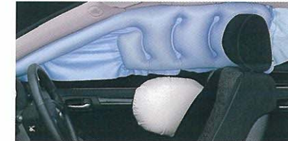
■写真は機能説明のためにSRSエアバッグが作動した状態を再現したものです。なお、SRSサイドエアバッグ、SRSカーテンシールドエアバッグは、実際の衝突時には衝突側のみ膨らみます。
