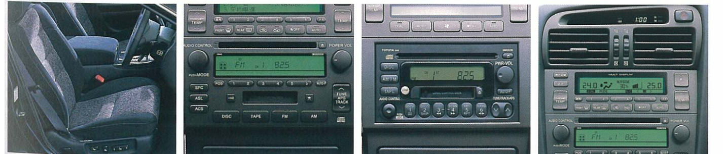
⑬マルチアジャスタブルパワーシート 運転席8ウェイ、助手席4ウェイのアジャスト機構を備え、つねに最適な着座ポジションが得られます。 ⑭アリスト・プレミアムサウンドシステム (カセット一体AM/FMマルチ電子チューナーラジオ+CDプレーヤー) ⑮カセット一体AM/FMマルチ電子チューナーラジオ+CDプレーヤー ⑯左右独立温度コントロールマイコンオートエアコン 運転席側・助手席側でそれぞれ独自の温度設定が可能です。またセンサーからの日射量情報をもとに、きめ細かな室温のコントロールを行います。 *画面はハミ込み合致です。
