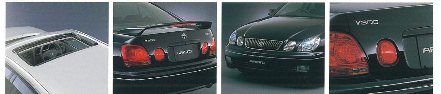
⑤チルト&スライド電動ムーンルーフ(挟み込み防止機能付) ワンタッチで爽快なクルージングがたのしめます。チルトアップ機構により、室内の換気性能にも優れています。 ⑥LEDハイマウントストップランプ付リヤスポイラー ワンタッチで爽快なクルージングがたのしめます。チルトアップ機構により、室内の換気性能にも優れています。 ⑦オートレベリング機能付 ディスチャージヘッドランプ(ロービーム)従来のハロゲンヘッドランプに比べて、約70%の消費電力で、より太陽光に近い色と約2倍もの明るさ、そしてワイドな照射範囲で夜間走行時の視認性を高めます。 ⑧リヤフォグランプ 降雪や濃霧などの悪天候下で後続車からの被視認性を確保します。 リヤフォグランプを装着した場合、テールランプの点灯状態が変わります。
