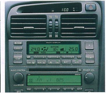
⑯左右独立温度コントロールマイコンオートエアコン 運転席側・助手席側でそれぞれ独自の温度設定が可能です。またセンサーからの日射量情報をもとに、きめ細かな室温のコントロールを行ないます。 *画面はハメ込み合成です。
