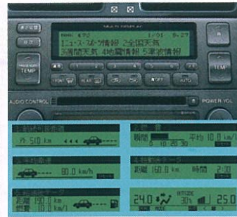
⑪FM文字多重放送対応マルチディスプレイ 天気予報、交通情報などの情報が得られるFM文字多重放送のほか、燃費、走行距離をはじめとする「クルーズインフォメーション」や「車両オーナーリング」も表示されます。 *安全のためFM文字多重放送は走行中表示されません。画面はハメ込み合成です。
