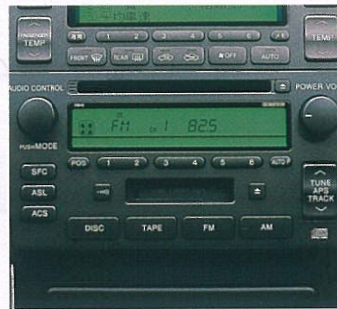
⑭アリスト・プレミアムサウンドシステム (カセット一体AM/FMマルチ電子チューナーラジオ+CDプレーヤー)
