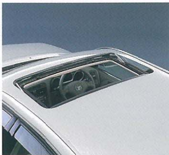
⑤チルト&スライド電動ムーンルーフ(挟み込み防止機能付) ワンタッチで爽快なクルージングがたのしめます。チルトアップ機構により、室内の換気性能にも優れています。
