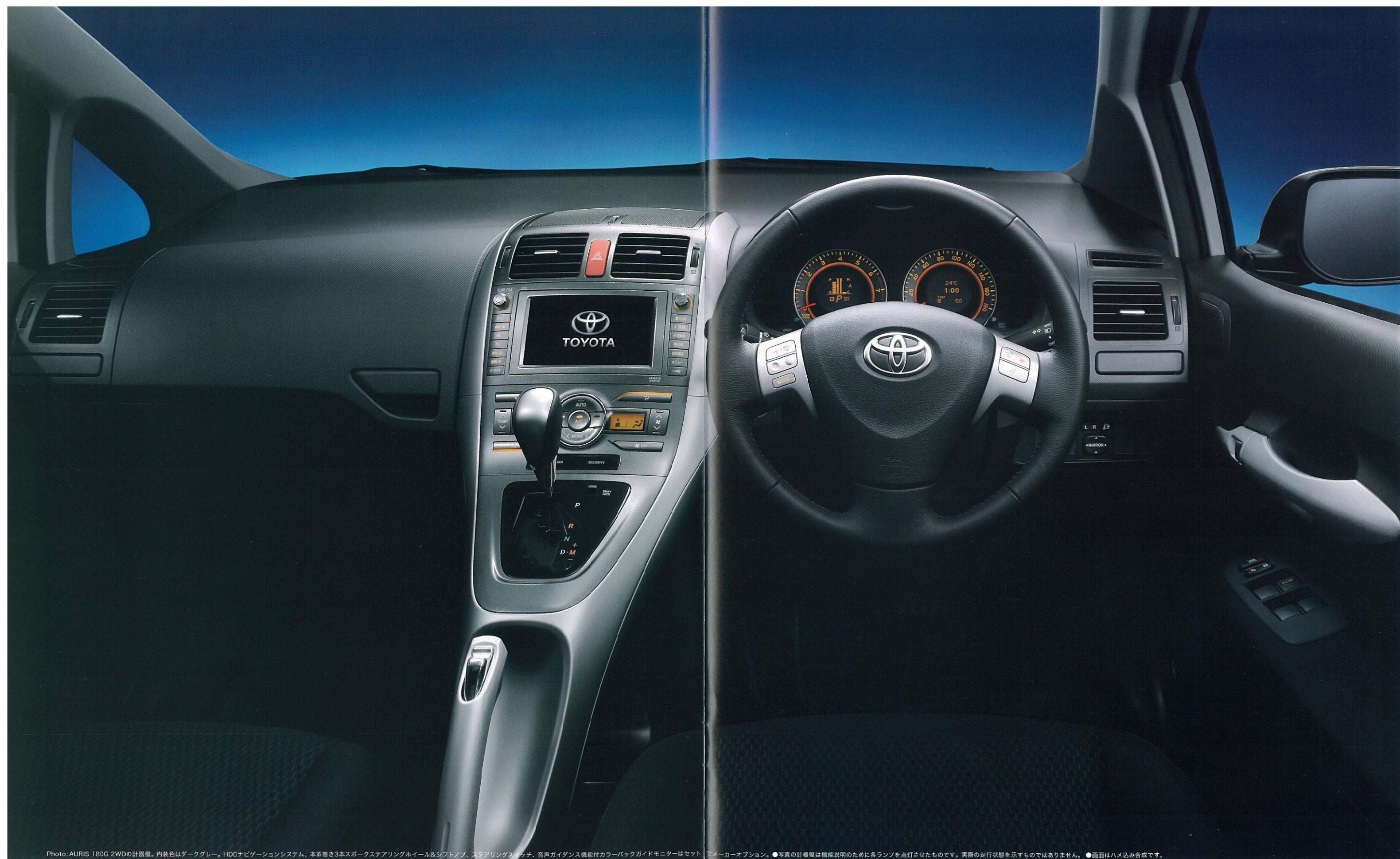
Photo: AURIS 180G 2WDの計器盤。内装色はダークグレー。HDDナビゲーションシステム、本革巻き3本スポークステアリングホイール&シフトノブ、ステアリングスイッチ、音声ガイダンス機能付カラーバックガイドモニターはセットでメーカーオプション。●写真の計器盤は機能説明のために各ランプを点灯させたものです。実際の走行状態を示すものではありません。●画面はハメ込み合成です。
