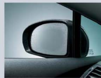
サイドターンランプ付電動格納式リモコン カラードアミラー(タイマー&ヒーター付) ドアミラーのくもりを防止するヒーターを内蔵。 リアウインドゥデフォグと連動して作動。
