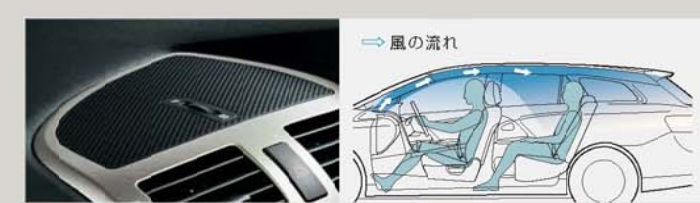
アッパーベント センタークラスター上部から天井に沿って送風。室内に風を循環させ、後席も 快適な状態に保ちます。
