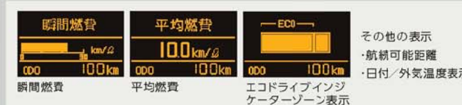
マルチインフォメーションディスプレイ メーター中央部に設定。表示の切り替えは、メーター内スイッチおよびステア リングスイッチ*2で行えます。
