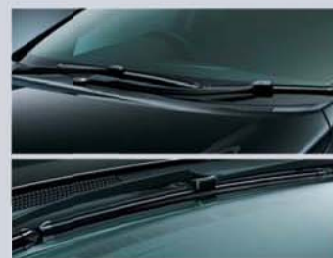
フラットワイパーブレード*3 雨滴感知式のフロントワイパーには、 前方視界を妨げないフラットな形状 のワイパーブレードを採用。
