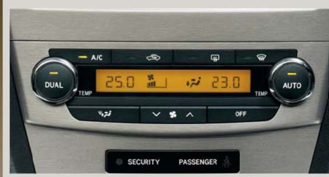
左右独立温度コントロールフルオートエアコン 運転席側と助手席側で、それぞれの好みに応じた温度設定が可能。エアコン による「冷え」が苦手な人にもうれしい機能です。
