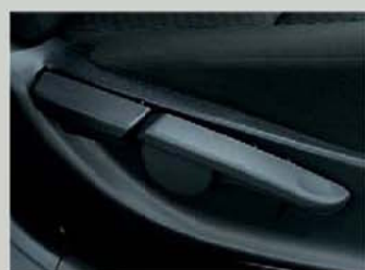
シートアジャスター (運転席6ウェイ・助手席4ウェイ) ドライバーの体格に合わせて、最適 な運転姿勢を確保するために。リク ライニングとシートリフターを備え た無段階調節のシートアジャスター を設定。操作しやすい大型レバーを 採用しています。
