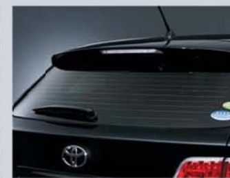
リアウインドゥデフォグ(タイマー付) 寒い朝や湿度の高い日などに、ガラス の結露や凍結を取り除き、後方視界 を確保します。
