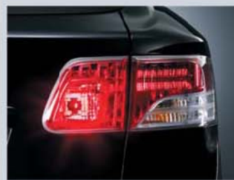
リアフォグランプ(右側のみ) 霧・雨・雪などの悪天候の走行時、後方車 両からの被視認性向上に貢献します。 リアコンビネーションランプ右側に設定。
