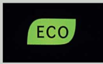
エコドライブインジケータランプ 環境に配慮したアクセル操作をして いる時に点灯。エコ運転をサポート します。
