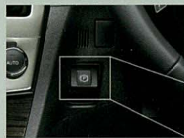
■ エレクトリックパーキングブレーキ 操作しやすく、足元スペースにもゆとりを生む電気式のパーキングブレーキ。ボタンを押すとブレーキがかかり、引くと解除。
