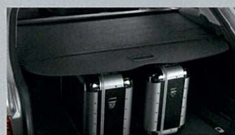
■トノカバー 取り外してデッキボックスに収納することも可能。
