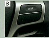
B マルチインフォメーションディスプレイスイッチ*2
