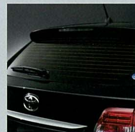
■ リヤウインドウデフォグ (タイマー付) ガラスの結露や凍結を取り除き、後方視界を確保します。
