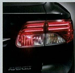
■ リヤフォグランプ (右側のみ) 霧・雨・雪などの悪天候の走行時、後方車両からの被視認性向上に貢献します。
