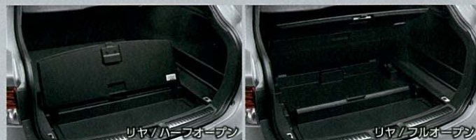
■デッキボード(フロント・リヤ・サイド) 荷物の出し入れがしやすい自立可能なリヤデッキボードを採用。
