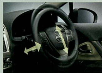
■ チルト&テレスコピック機能付ステアリング
