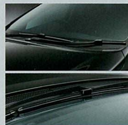
■ フラットワイパーブレード*3 前方視界を妨げないフラットな形状のワイパーブレードを採用。
