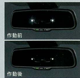
■ 自動防眩インナーミラー 光の度合いに応じて鏡面の反射状態を変化。視認性の低下をやわらげます。[Liに標準装備]
