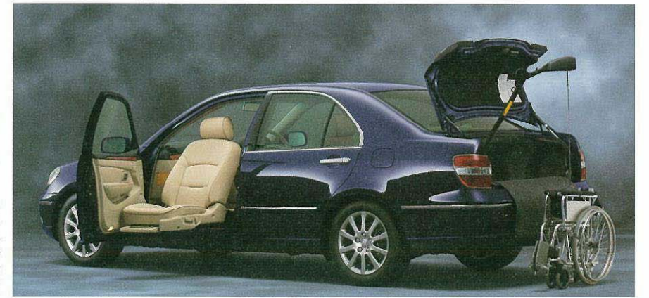
Photo: プレビスA250 全自動助手席回転スライドシート車 "Bタイプ" (TAJCG10-VRKFAVC)。ボディカラーはダークブルーマイカ(8P8)。チルト&スライド電動ムーンルーフ(ワンタッチ式・扶き込み防止機能付)、DVDボイスナビゲーション付EMV(エレクトロマルチビジョン)、NAVI-AI-SHIFT、バックガイドモニター、パーソナルライティングポジションシステム、レーダークルーズコントロール、電動リヤサンシェード、DVD/MD一体AM/FMマルチ電子チューナー付ラジオ(8スピーカー)はメーカーオプション。車いすは架装メーカーオプション。
