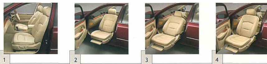
Photo: プレビスA250 全自動助手席回転スライドシート車 "Bタイプ"。ボディカラーはダークブルーマイカ (8S6)。オプション装着車。
