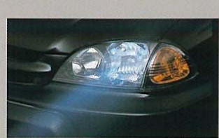
ディスチャージヘッドランプ (ロービーム・オートレベリング機能付)
