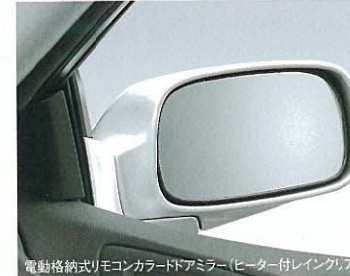
電動格納式リモコンカラードアミラー (ヒーター付レインクレンジング機能付)
