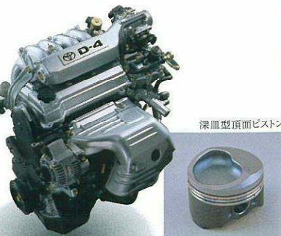
BEAMS 3S-FSE VVT-i (16VALVE EFI) D-4 二酸化炭素排出量: 20%削減(3S-FE比) 総排気量: 1.998ℓ 最高出力(ネット): 107kW(145PS)/6,000r.p.m. 最大トルク(ネット): 196N-m(20.0kg-m)/4,400r.p.m. 10-15モード走行燃費(国土交通省審査値): 15.4km/ℓ
