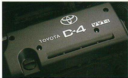
BEAMS 1AZ-FSE VVT-i (16VALVE EFI) D-4 総排気量：1.998ℓ 最高出力(ネット)：112kW(152PS)/6,000r.p.m. 最大トルク(ネット)：200N・m(20.4kg・m)/4,000r.p.m. 10・15モード走行燃費(国土交通省審査値)：15.4 km/ℓ
