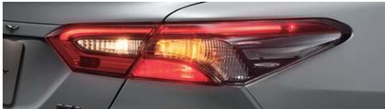
LEDリヤコンビネーションランプ（テール・ストップ・サイドマーカールamp）＊1
