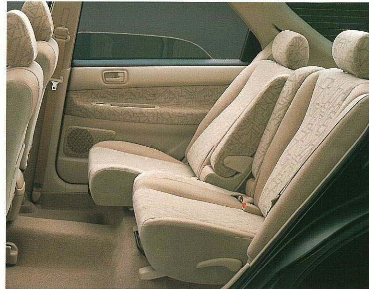
5:5分割可倒式リヤシート (シートスライド&リクライニング機構付) 左右それぞれに、最大170mmのスライドとリクライニングが可能。左右独立したアームレスト(カップホルダー内蔵)も、シートと一緒に移動します。また、リヤのヘッドレストは前後・上下調整式です。
