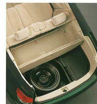
スペアタイヤ収納スペース スペアタイヤは、デッキアンダートレイよりもさらに一段下に効率よく収納されています。
