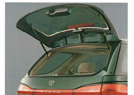
ガラスハッチ ハッチを開いた状態でバックドアを開けても、ハッチが動かない新機構を採用。誤って天井などにぶつける心配がありません。
