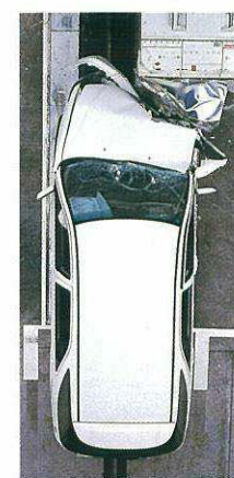
●オフセット前面衝突実験(64km/h) [写真は実験用の試作車です]
