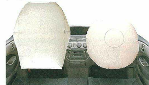
●写真は機能説明のために、デュアルSRSエアバッグが作動した状態を再現したものです。
