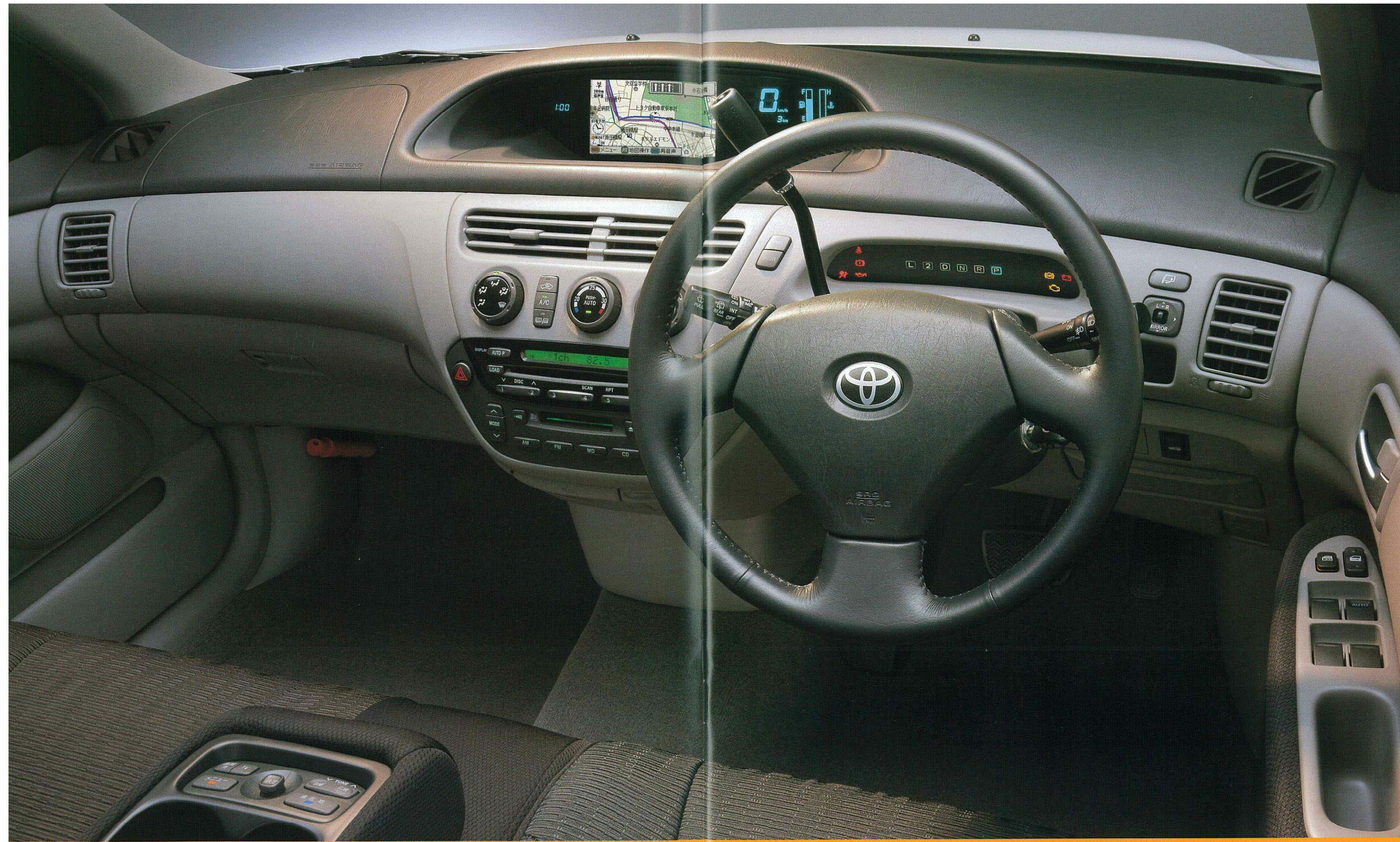
Photo:200Sの計器盤。内装色はストーン。 マルチパーパスベンチシートはメーカーオプション。DVDボイスナビゲーション付EMV(エレクトロマルナビジョン)、 7インチワイド・マルチディスプレイ、ダイバシティ&TVアンテナはセットでメーカーオプション。
