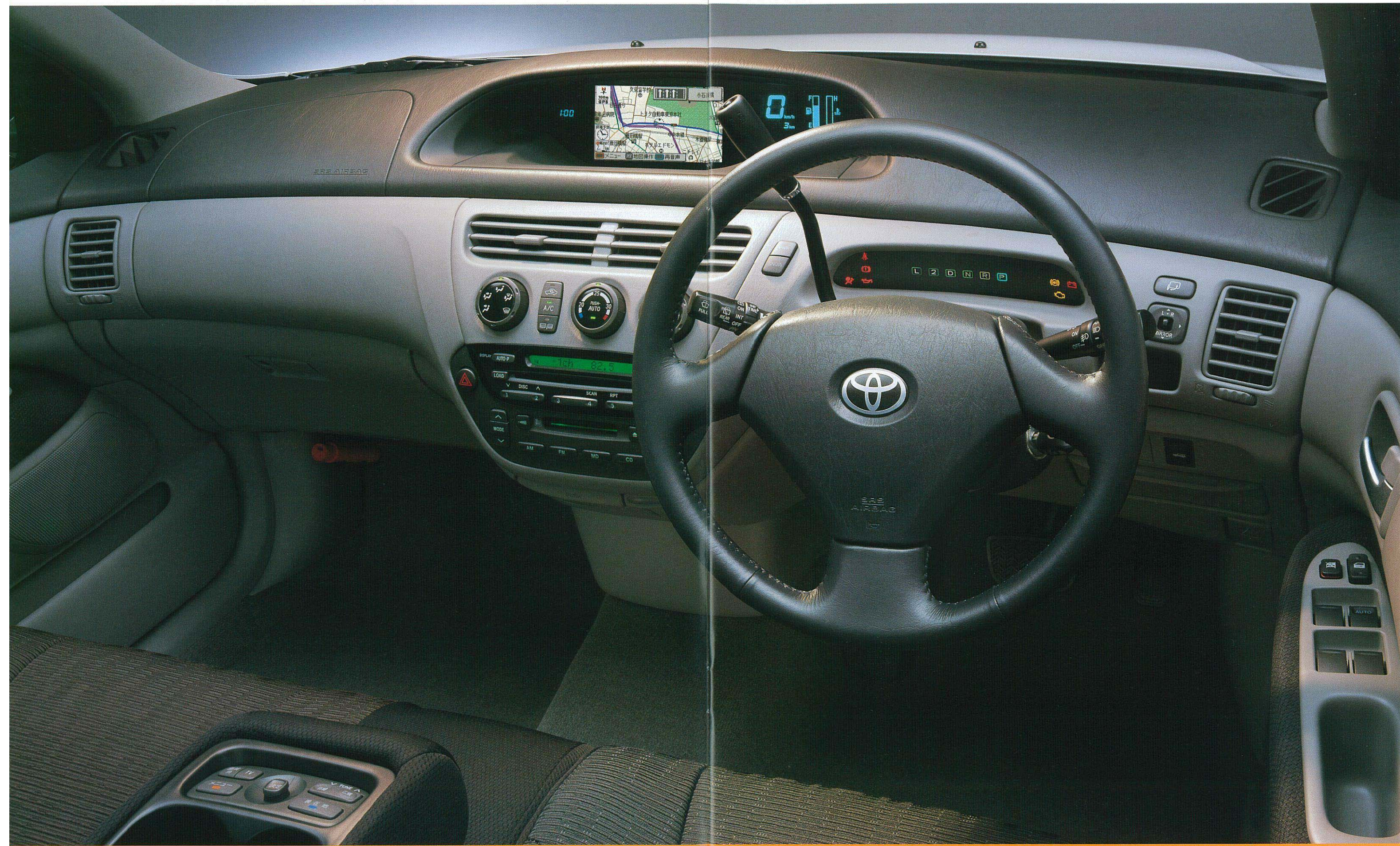
Photo:200Sの計器盤。内装色はストーン。 マルチパーパスベンチシートはメーカーオプション。DVDボイスナビゲーション付EMV(エレクトロマルチビジョン)、 7インチワイド・マルチディスプレイ、ダイナシティ&TVアンテナはセットでメーカーオプション。
