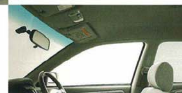
フロントウィンドシールドガラス (高熱吸合合わせグリーン・トップシェード付)
