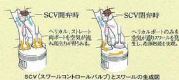
SCV (スワールコントロールバルブ)とスワールの生成図
