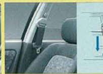
前席ELR付3点式シートベルト（プリテンショナー&フォースリミッター機構付）
