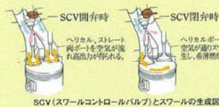
SCV(スワールコントロールバルブ)とスワールの生成図
