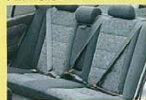
後席ELR付3点式シートベルト（チャイルドシート固定機構付）
