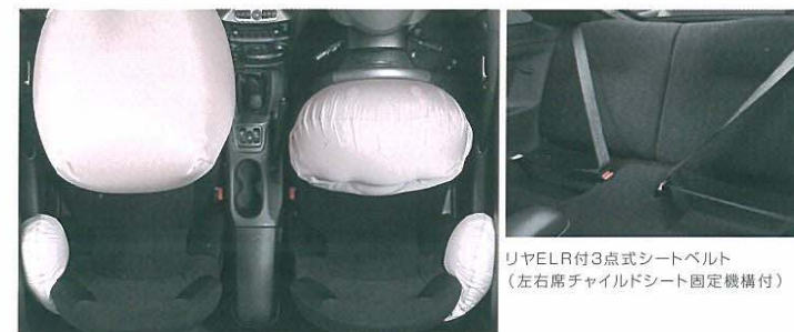
デュアルSRSエアバッグ&SRSサイドエアバッグ（運転席・助手席） ●写真は機能説明のためにすべてのSRSエアバッグが作動した状態を再現したものです。なお、SRSサイドエアバッグは、実際の衝突時には衝突側のみ膨らみます。
