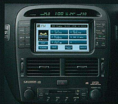
セルシオ“マークレヴィンソン”プレミアムサウンドシステム システム構成 ■マークレヴィンソン DSP*アンプ ■マークレヴィンソン専用・ネオジウム採用11スピーカー(7箇所配置) ●インパネ2ウェイシステム(65mmミッドレンジ+20mmホーンツイーター) ●フロントドア・16cmミッドウーハー ●2ウェイリヤドアシステム (20mmチタニウムドームツイーター+12cmミッドレンジスピーカー) ●リヤデッキ20cmサブウーファー *音質・音場の切り替え機能の一部はありません。
