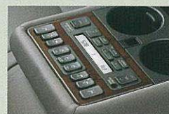
オーディオ・空調コントローラー
