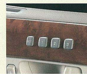
マイコンプリセット ドライビングポジションシステム
