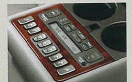
オーディオ・空調コントローラー
