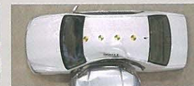
Car to Car SUV側面衝突実験 (50km/h 写真は実験用試作車です。)
