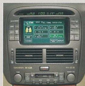
カセット一体AM/FMマルチ電子チューナーラジオ&インダッシュ6連奏DVDオートチェンジャー+G-BOOK対応DVDボイスナビゲーション付EMV
