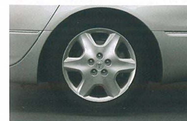
225/55R17 95W+17×7.5JJアルミホイール (スーパークロームメタリック)
