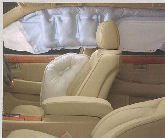
●SRSサイドエアバッグ(運転席・助手席)& SRSカーテンシールドエアバッグ(前後席)
