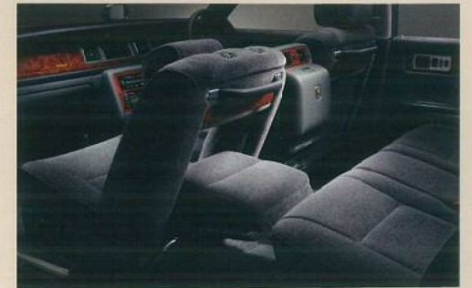
前倒式ヘッドレスト&オートマン機能付助手席シート ●写真は機能説明のためボディの一部を切断したカットモデルです。
