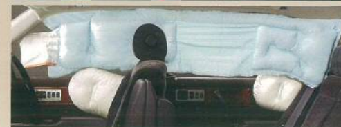
*3.SRS [乗員保護補助装置] Supplemental Restraint System ■エアバッグは、あくまでシートベルトを補助する装置です。必ずシートベルトを着用ください。 ■写真は機能説明のためにエアバッグが作動した状態を再現したものです。 ■SRSエアバッグ、SRSサイドエアバッグ、SRSカーテンシールドエアバッグは、衝突の条件によっては作動しない場合があります。また、実際の衝突時には衝突側のみ膨らみます。
