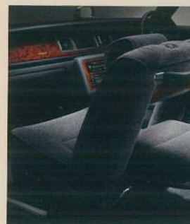
前倒式ヘッドレスト&オートマン機能付助手席シート ●写真は機能説明のためボディの一部を切断したカット
