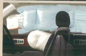
*3. SRS (乗員保護補助装置: Supplemental Restraint System)。 ■エアバッグは、あくまでシートベルトを補助する装置です。必ず ■写真は機能説明のためにエアバッグが作動した状態を再現 ■SRSエアバッグ、SRSサイドエアバッグ、SRSカーテンシェールが 場合があります。また、実際の衝突時には衝突箇のみ膨らみ
