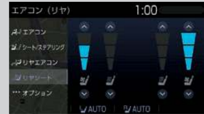
後左右席シートベンチレーション(メーカーオプション)/後左右席シートヒーター
