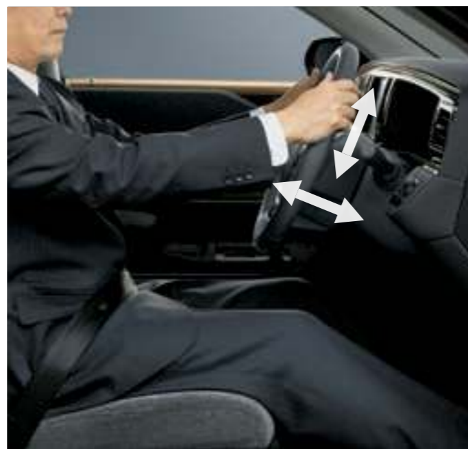
電動チルト&テレスコピックステアリング(オートチルトアウェイ&リターン機能付)
