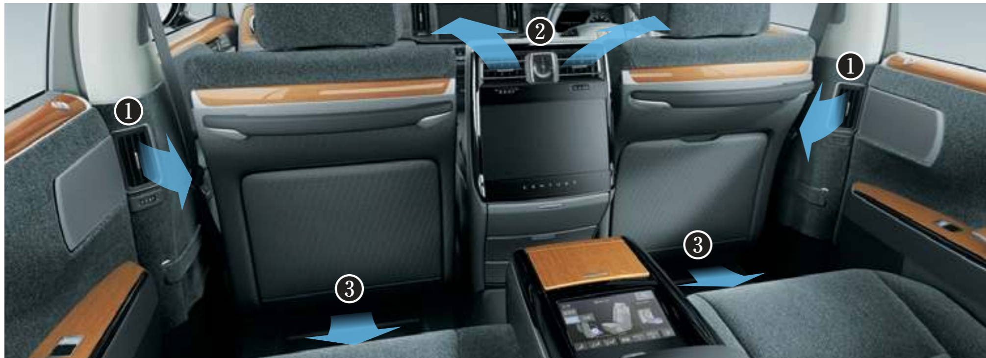
後席エアコン吹き出し口 ①センターピラー ②タワーコンソール ③フロア
