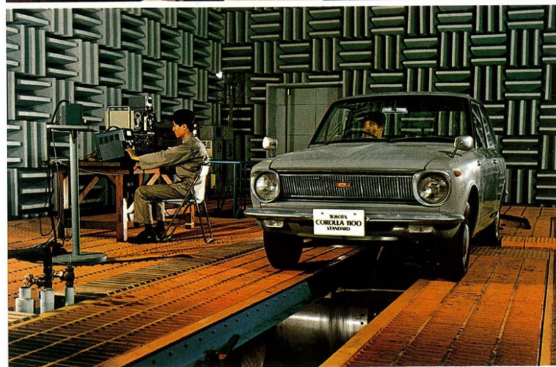
大きな無響室に車を入れて、騒音を測定。これならという折紙がつけられました。
