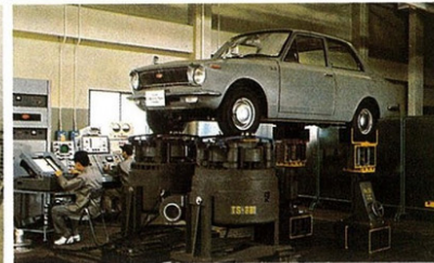
車輪をばねしく上下に動かし懸架装置の震動をテスト。
