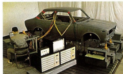
車体に強い力を加えてねじれをテスト。
