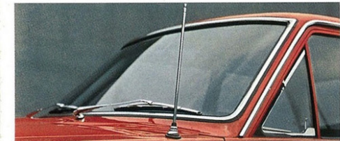
ラジオのスイッチをいれると自動的に1段とび出すマグネット・アンテナ。
