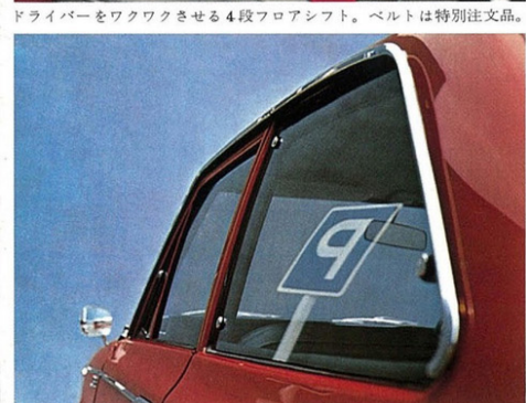
大きくカーブした曲面ガラスが車体の空気抵抗をへらしています。
