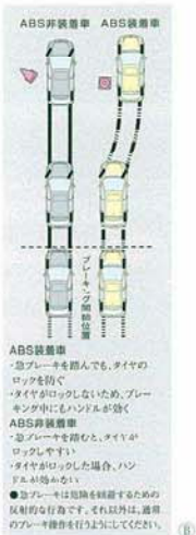
ABS装着車 ・急ブレーキを踏んでも、タイヤのロックを防ぐ ・タイヤがロックしないため、ブレーキ途中にもハンドルが強く ABS非装着車 ・急ブレーキを踏むと、タイヤがロックしやすい ・タイヤがロックした場合、ハンドルが跳ねる ●急ブレーキは危険を回避するための反射的な行為です。それ以外には、通常のブレーキ操作を行うようにしてください。
