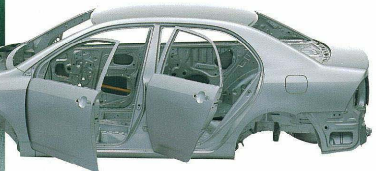
衝突安全ボディ“GOA” *GOA=Global Outstanding Assessment：世界トップレベルの安全性評価という意味。 ●写真のサイドドアビームは機能説明のために着色したものです。
