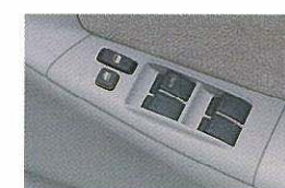
パワーウインドウ (運転席ワンタッチ式、換み込み防止機能付) & ドアキー連動電気式ドアロック
