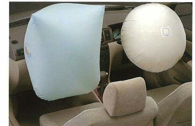
デュアルSRSエアバッグ *写真は機能説明のためにSRSエアバッグが作動した状態を再現したものです。 SRS [乗員保護補助装置] : Supplemental Restraint System *チャイルドシート等を助手席に装着するときは、後ろ向きにしないなど、ご注意ください。必ず取扱書をご覧ください。
