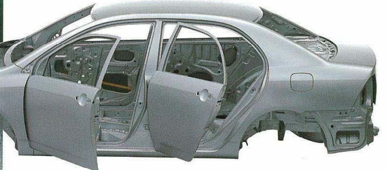
衝突安全ボディ“GOA” *GOA = Global Outstanding Assessment : 世界トップレベルの安全性評価という意味。 ●写真のサイドエアビームは機能説明のために着色したものです。
