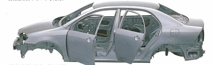
衝突安全ボディ“GOA” *GOA = Global Outstanding Assessment : クラス世界トップレベルを追求している安全性評価 ●写真のサイドドアビームは機能説明のために着色したものです。
