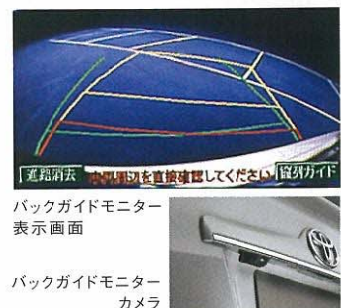
音声ガイダンス機能付バックガイドモニター説明図
