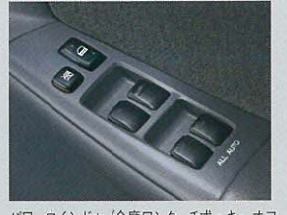
パワーウィンドウ (全席ワンタッチ式・キーオフ後作動遅延・挟み込み防止機能付)&ドアキー運動電気式ドアロック
