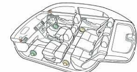
6スピーカー配置図 2.5cmフロントツイーター 16cmフロントスピーカー 14cmリヤスピーカー
