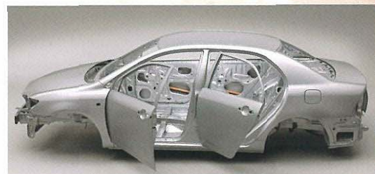
衝突安全ボディ“GOA” ●写真のサイドドアビームは機能説明のために着色したものです。
