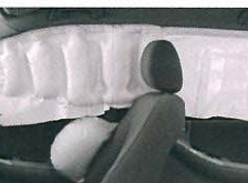
SRSサイドエアバッグ&SRSカーテンシールドエアバッグ
