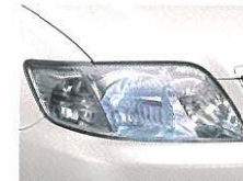
ディスチャージヘッドランプ (ロービーム・オートレベリング機能付)
