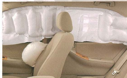
SRSサイドエアバッグ&SRSカーテンシールドエアバッグ ●SRSエアバッグの写真は機能説明のために作動した状態を再現したものです。
