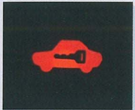
盗難防止システム (エンジン immobilizer システム)
