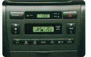
オートエアコン&プッシュ式デジタルヒーターコントロールパネル (外気温度表示機能付)
