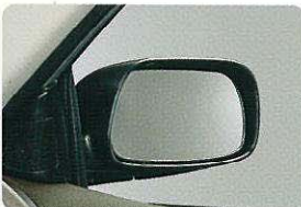
電動格納式リモコンカラードアミラー(レイングリッピングミラー)
