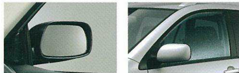
レインクリアリングドアミラー 撥水機能付フロントドアガラス
