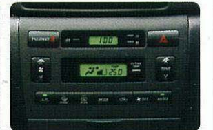
オートエアコン&プッシュ式デジタルヒーターコントロールパネル (外気温度表示機能付)
