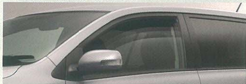
●パワーウィンドウ(前後ドアワンタッチ式、キーオフ後作動機能、挟み込み防止機能付)
