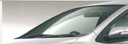
●UVカット機能付ウインドシールドグリーンガラス(熱吸合わせ)
