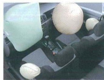
デュアルSRSエアバッグ&SRSサイドエアバッグ(運転席・助手席)
